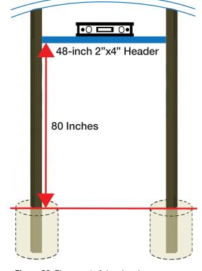
Figure 26. Placement of door header.
